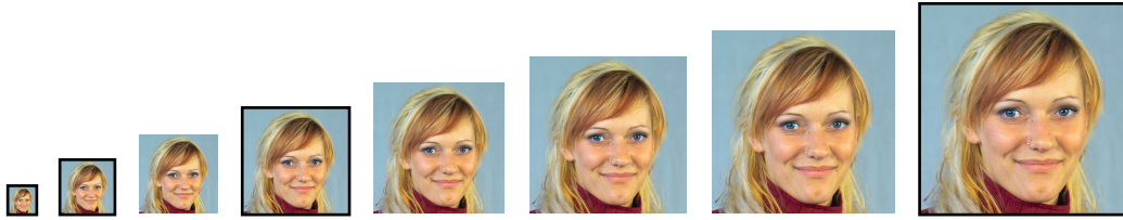
Abbildung: Auflösungsfolge in arithmetischer Progression – Kennzeichen DCT-basierter Bildkodierungsverfahren. Die geometrische Folge erscheint als Untermenge der arithmetischen Folge (schwarz umrandete Bilder). Dazwischen gibt es die zusätzlichen Stufen der arithmetischen Folge.
