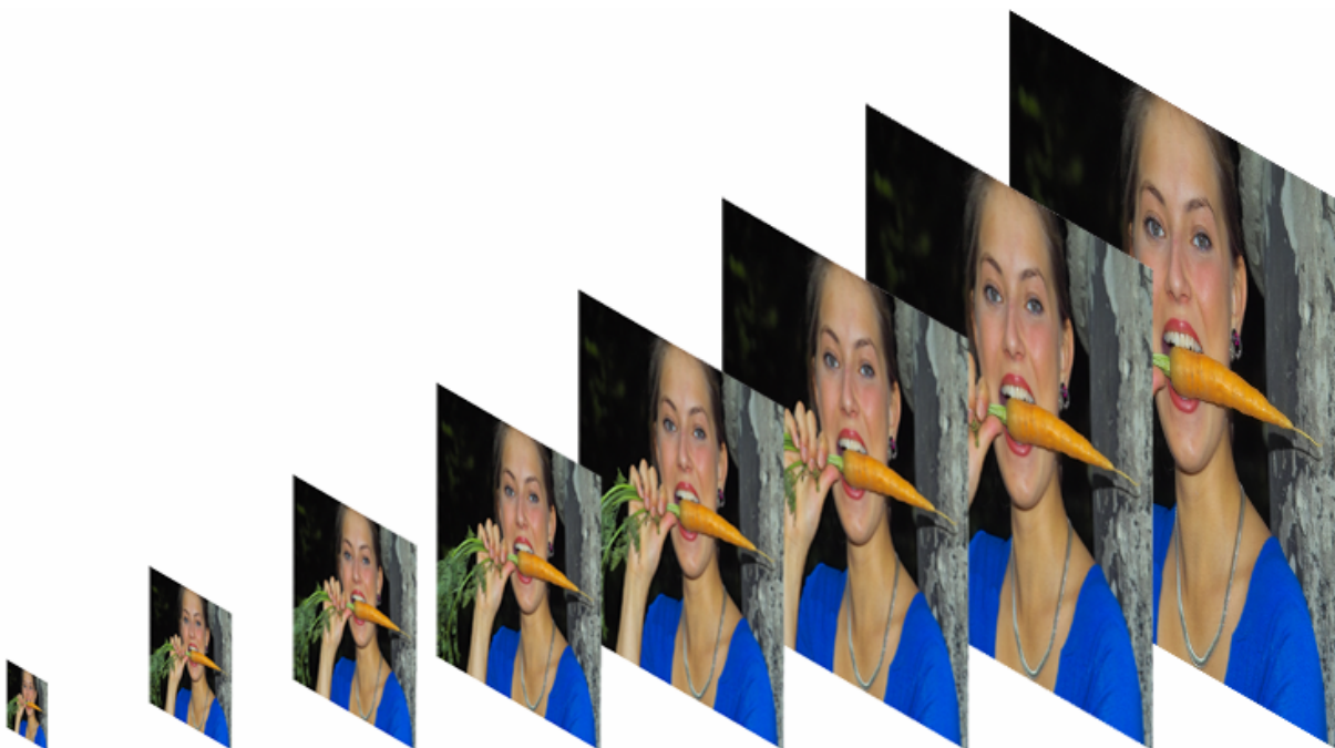
Abbildung: Auflösungsfolge in arithmetischer Progression – Kennzeichen DCT-basierter Bildkodierungsverfahren. Die geometrische Folge erscheint als Untermenge der arithmetischen Folge (schwarz umrandete Bilder). Dazwischen gibt es die zusätzlichen Stufen der arithmetischen Folge.
