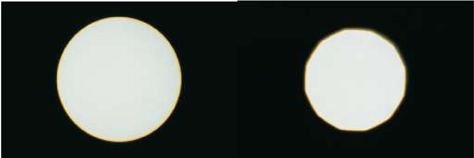
Daher ist ein Kompromiß zu finden! Typisch ist ca. 80% des Maximaldurchmessers der Aperturblende (ca. 2/3 der Fläche).
