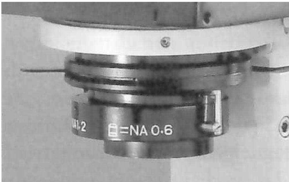
N.A. 1,2 oder 0,6, umschaltbar mit Klapplinse
