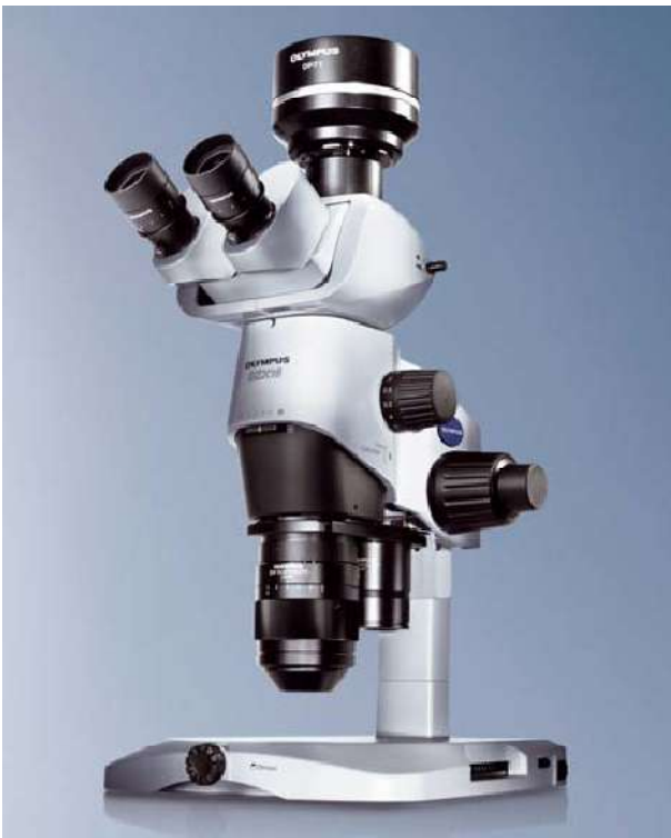
Olympus SZX10: Fernrohr-Typ (Galileo-Typ)
