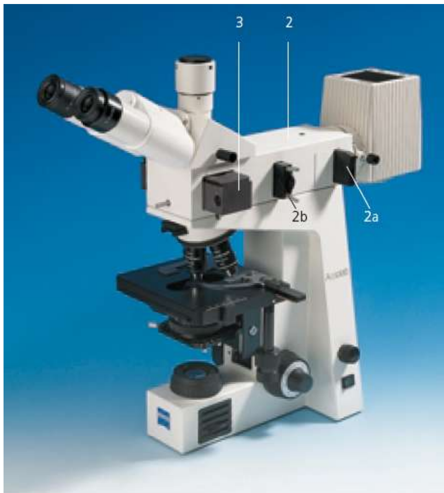
Zeiss Axiolab: 2: Auflichtilluminator, 2a: Absperr- und Filterschieber, 2b: Leuchtfeldblende, 3: Reflektorschieber
