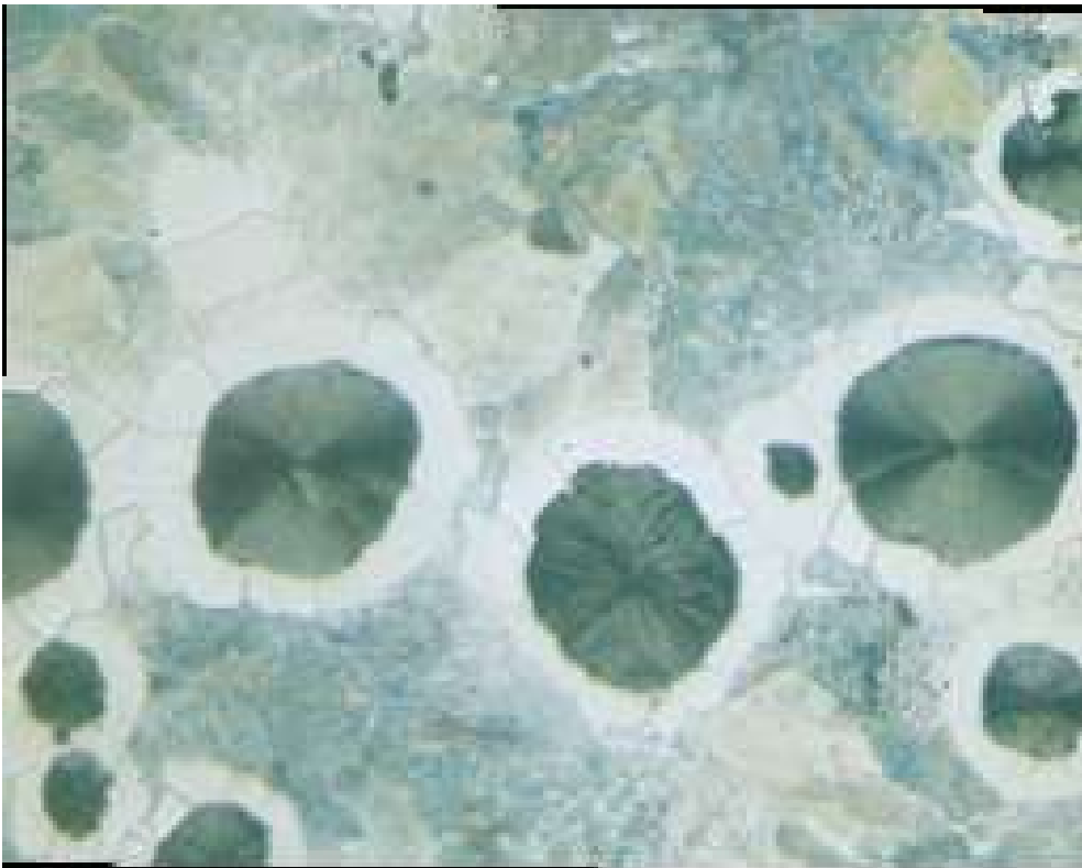
Sphärolitenstruktur der Gußprobe im Auflicht
