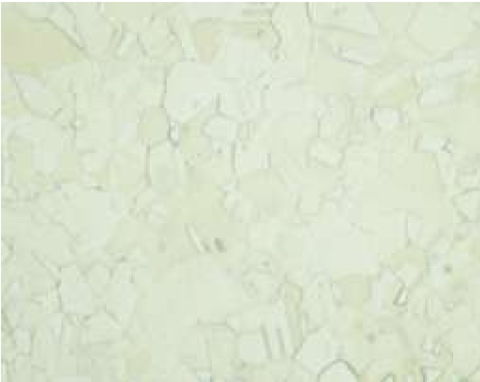
Gefüge einer Messingprobe: Hellfeld-Auflicht
