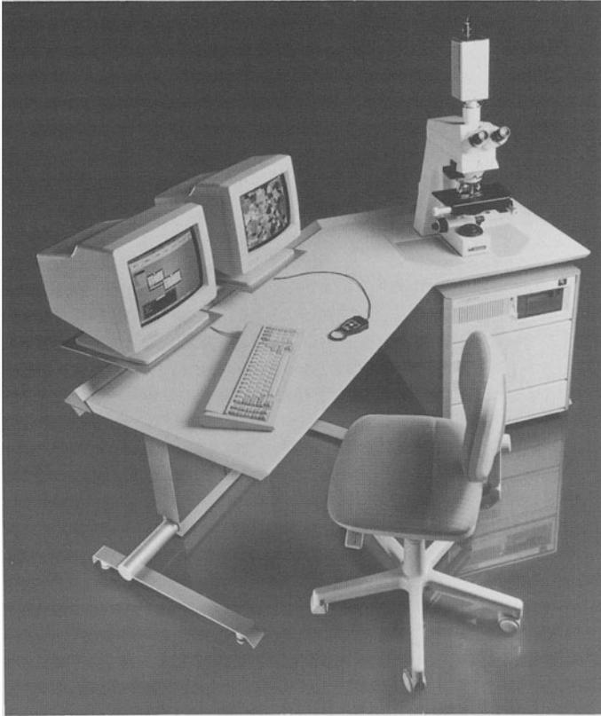
**Abb. 3.** Vollautomatisches Bildanalysesystem IBAS mit Durchlichtmikroskop AXIOPLAN, Scanningtisch und Hamamatsu-Meßkamera.
