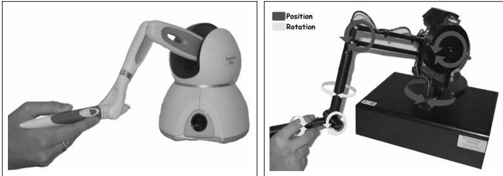
Abb. 9.41: Beispiele werkzeuggesteuerter haptischer Krafterückkopplungsgeräte der Fa. Sensable ® . Links ist ein 3DOF-Gerät zu sehen. Rechts ist ein 6DOF-Gerät dargestellt, dessen 6 Freiheitsgrade für die Positionierung und Rotation des Werkzeuges für die Ein- und die Ausgabe durch Pfeile illustriert werden.
