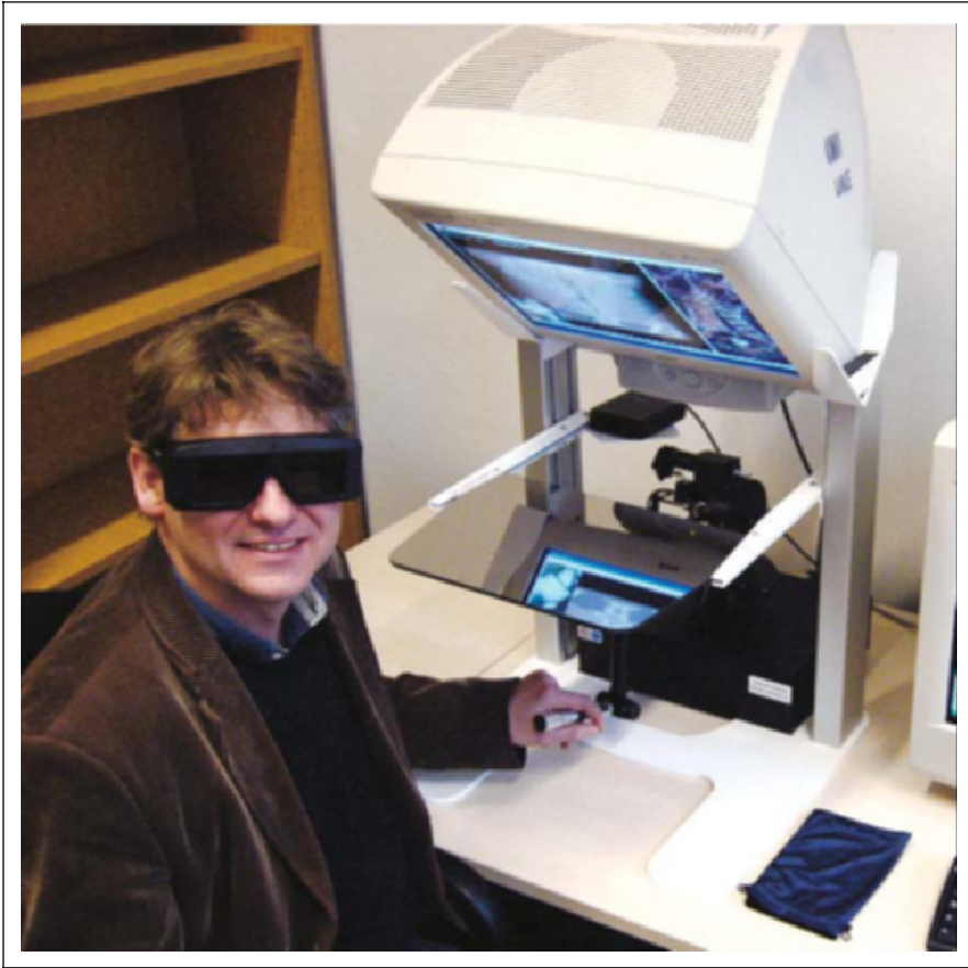
Abb. 10.38: Durch den Aufbau werden 3D-Stereobilder in den Arbeitsbereich des haptischen Krafrückkopplungsgerätes (Fa. Sensable ® ) gespiegelt, wodurch sich die Immersion des Benutzers erhöht. Das Bild zeigt den Autor mit einer Shutterbrille bei einer simulierten Lumbalpunktion.
