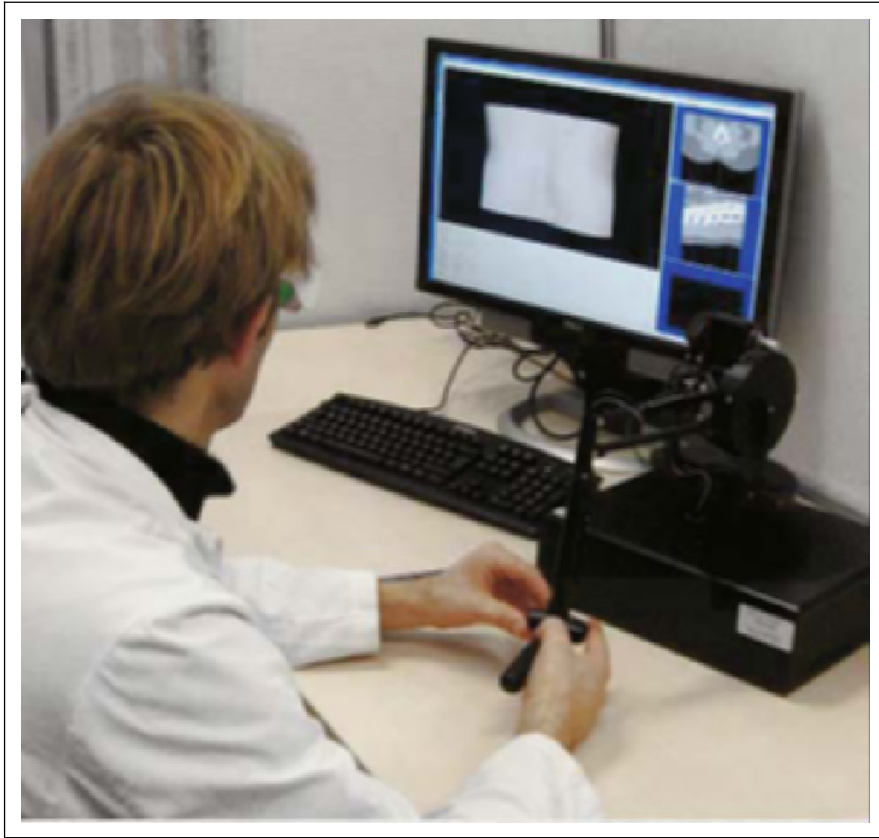
Abb. 10.37: Durchführung einer simulierten Lumbalpunktion. Der Mediziner steuert die virtuelle Punktionsnadel mit dem haptischen Gerät (Fa. Sensable ® ) und spürt z.B. beim Eindringen der Nadel in die Haut oder beim Durchstoßen der Bänder Widerstände.
