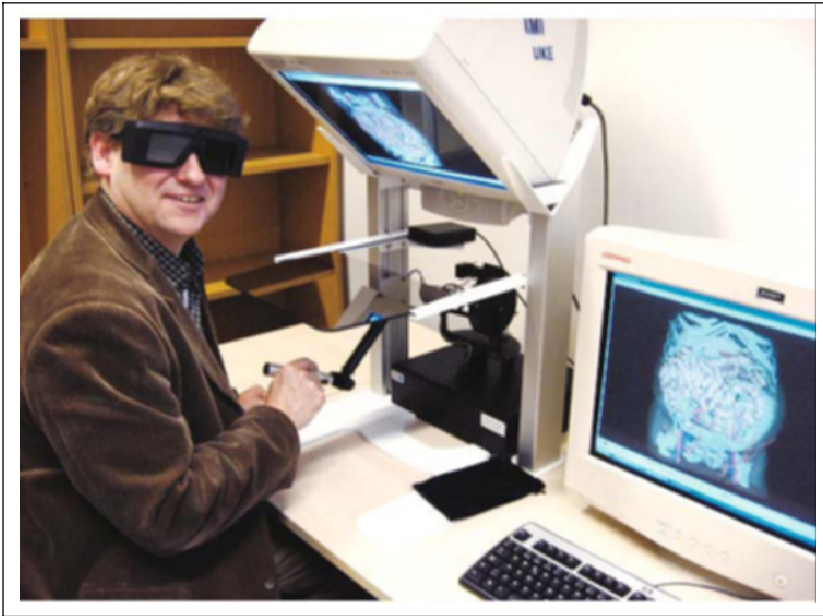
Abb. 9.39: Erhöhte Immersion des Benutzers durch Spiegelung der 3D-Stereobilder in den Arbeitsbereich des haptischen Kraffrückkopplungsgerätes (Fa. Sensable ® ). Der Spiegel ist zwischen dem Bildschirm und dem haptischen Gerät angebracht. Das Bild zeigt den Autor mit einer Shutterbrille bei einer Aszitespunktion am Punktionssimulator, bei der die durch das haptische Gerät gesteuerte virtuelle Punktionsschere bis zu einer Wasseransammlung im Bauchbereich vordringt.
